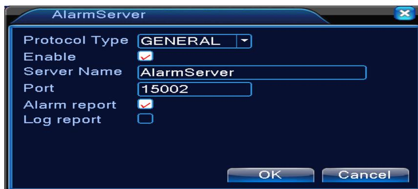
Imagen: 4.30 Configuración de servidor de alarma
